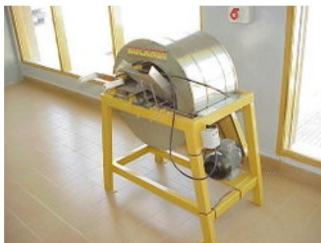
Fig. 14. Centrífuga para separación de la miel de los opérculos
