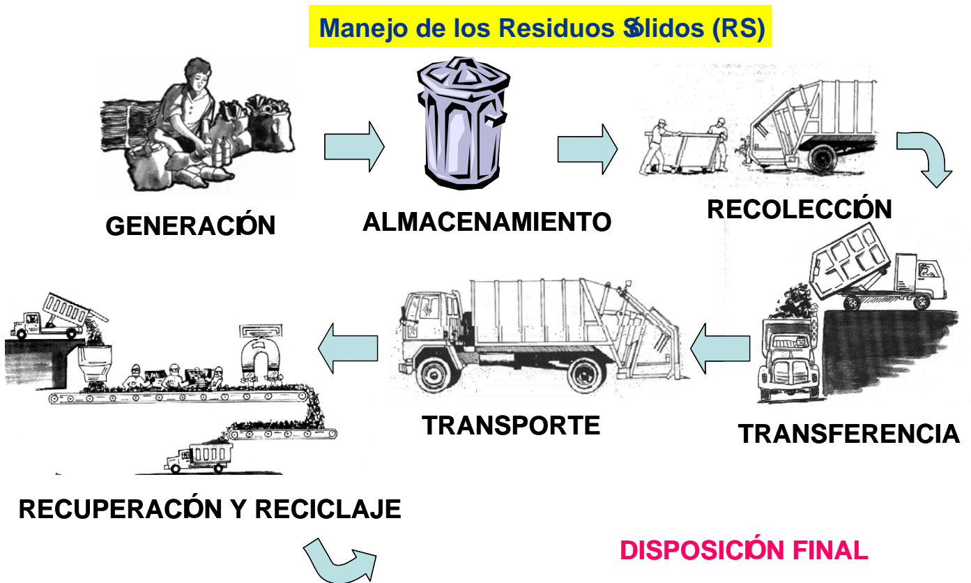
Fig. 3: Etapas para el Manejo y Gestión Integral de los (DSU y RSU)
