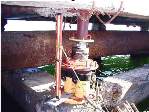
Figura 3. Prueba de Carga en el Puerto de Pastelillo. Nuevitas. Camaguey.
