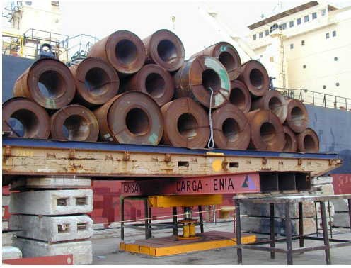
Figura 2. Prueba de Carga Puerto del Mariel. 250 Toneladas.
